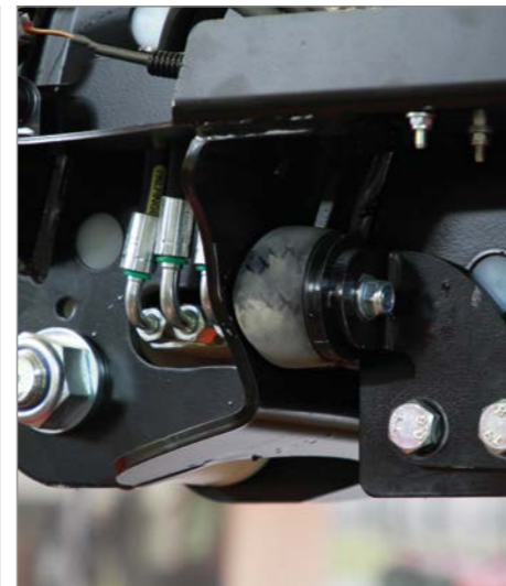
Endanschlagspuffer beim 4-fach Teleskop
