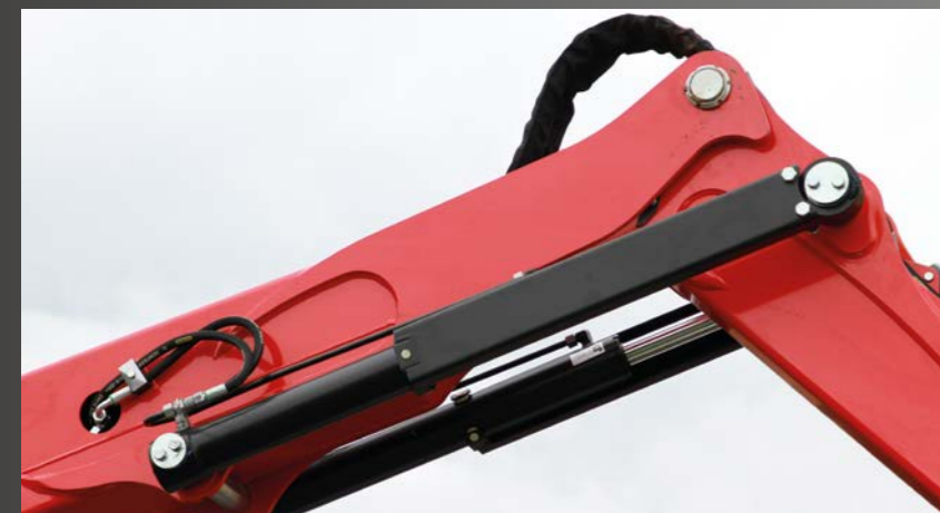
Starke kurze geschützte Zylinder
