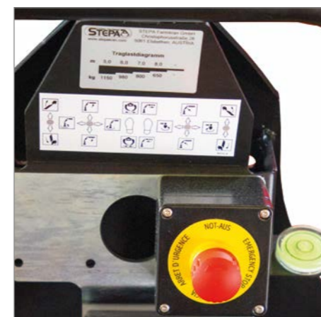
NOT-HALT Einrichtung immer in Griffweite
