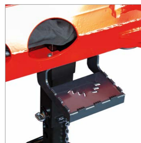
Sicherer Auftritt zum Stehpodest
