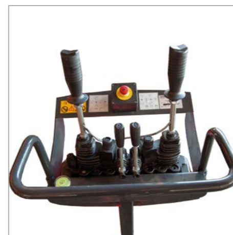
Standard ON-OFF 1- oder 2-Kreis Steuerung
