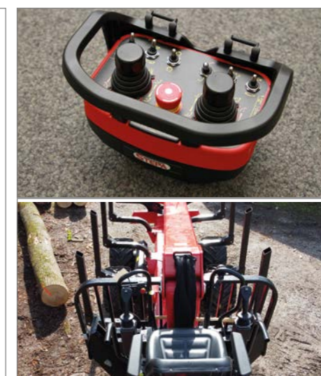
Funkfernsteuerung Joystick Hochsitz
