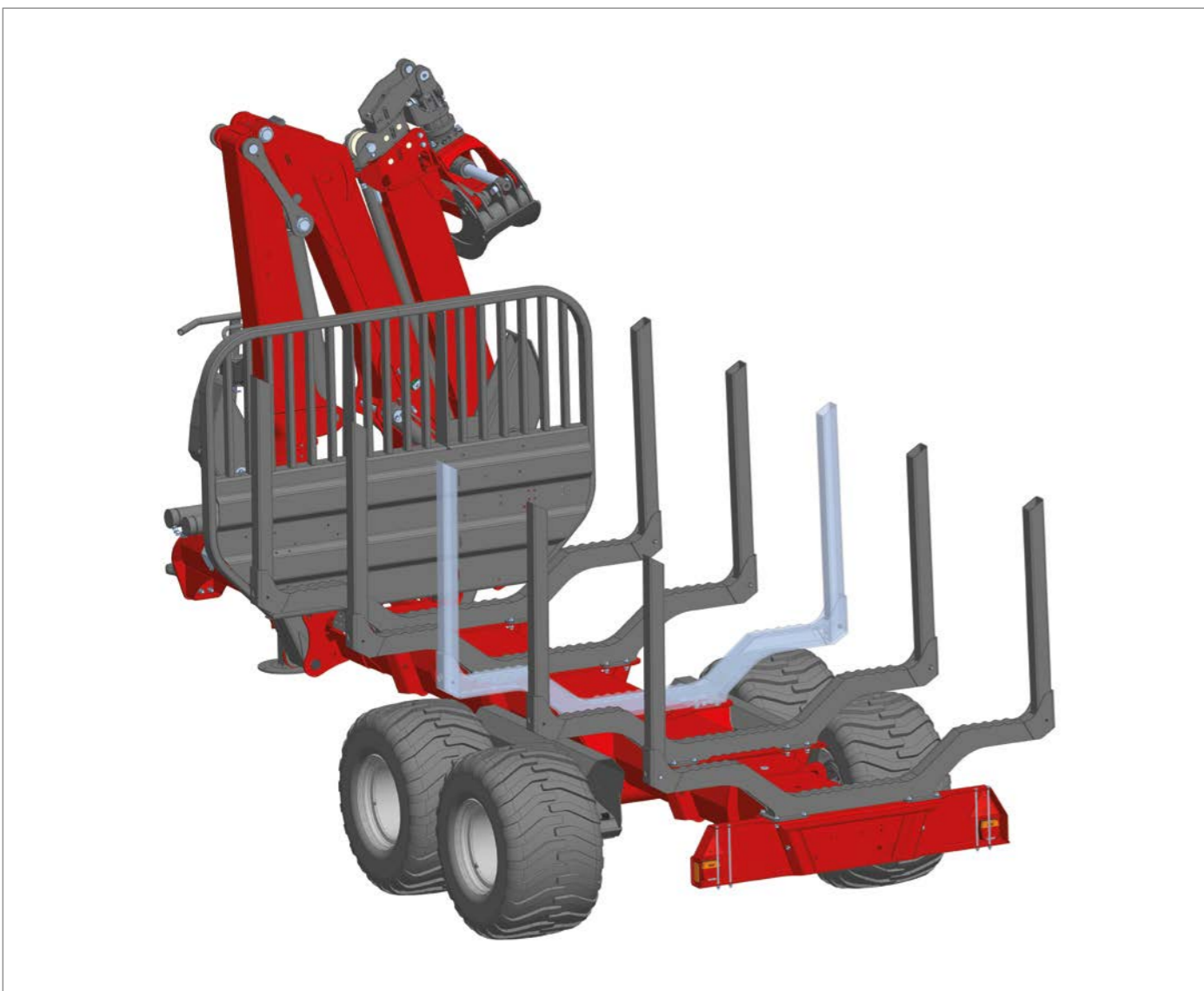
Forwarder Rungenbank optional für C- und M-Serie erhältlich
